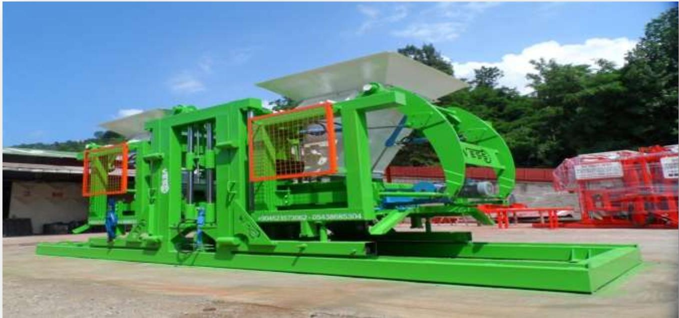
**LOWER VIBRATOR QUANTITY :** 2 x 7,5 kw. SPECIAL COUPLED SERVO-VIBROMOTOR./ **VIBRATOR COOLING FAN:** DUE THE SPECIAL PRODUCTION OF LOW-AMPERAGE THERE IS NO OVERHEATING PROBLEM./ **UPPER VIBRATOR QUANTITY:** 2 x 0,75 kw SPECIAL VIBROMOTOR./ VIBRATION COOLING CAPACITY : 22.000 Kcal. // **ALL VIBRATIONS:** IT GIVES A MINIMUM VIBRATION TO THE MACHINE BODY USING A SPECIAL DAMPENING SYSTEM.
