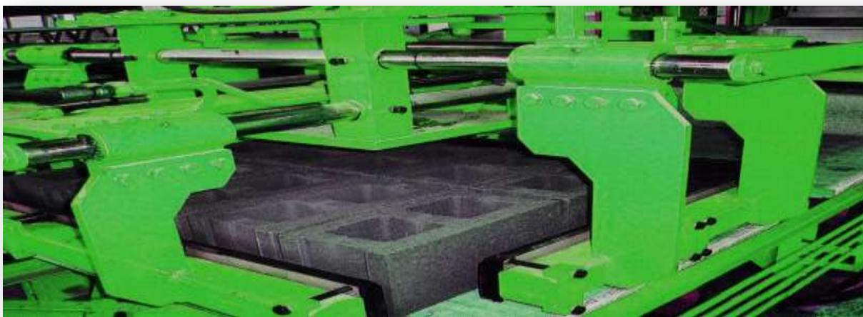
IT IS THE EQUIPMENT THAT STACKS THE DRIED PRODUCTS ON THE EURO PALLET. IT HAS THE CAPABILITY TO TURN AROUND 360°. IS PNEUMATICALLY DRIVEN AND ENSURES ACCURATE PROTECTION AGAINST CONCRETE BLOCK BREAKAGE. UP AND DOWN / RIGHT – LEFT AND GEAR WHEEL ROTATION MOVEMENTS; OPERATING SYSTEM DRIVEN BY SERVO MOTORS WITH REDUCERS. UP AND DOWN 7,5 kw./ RIGHT – LEFT 3 kw. AND GEAR WHEEL ROTATION 1,5 kw. HEIGHT MEASUREMENT MADE VIA LASER METER.
